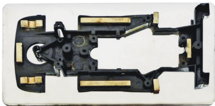
umístění magnetů na podvozku
